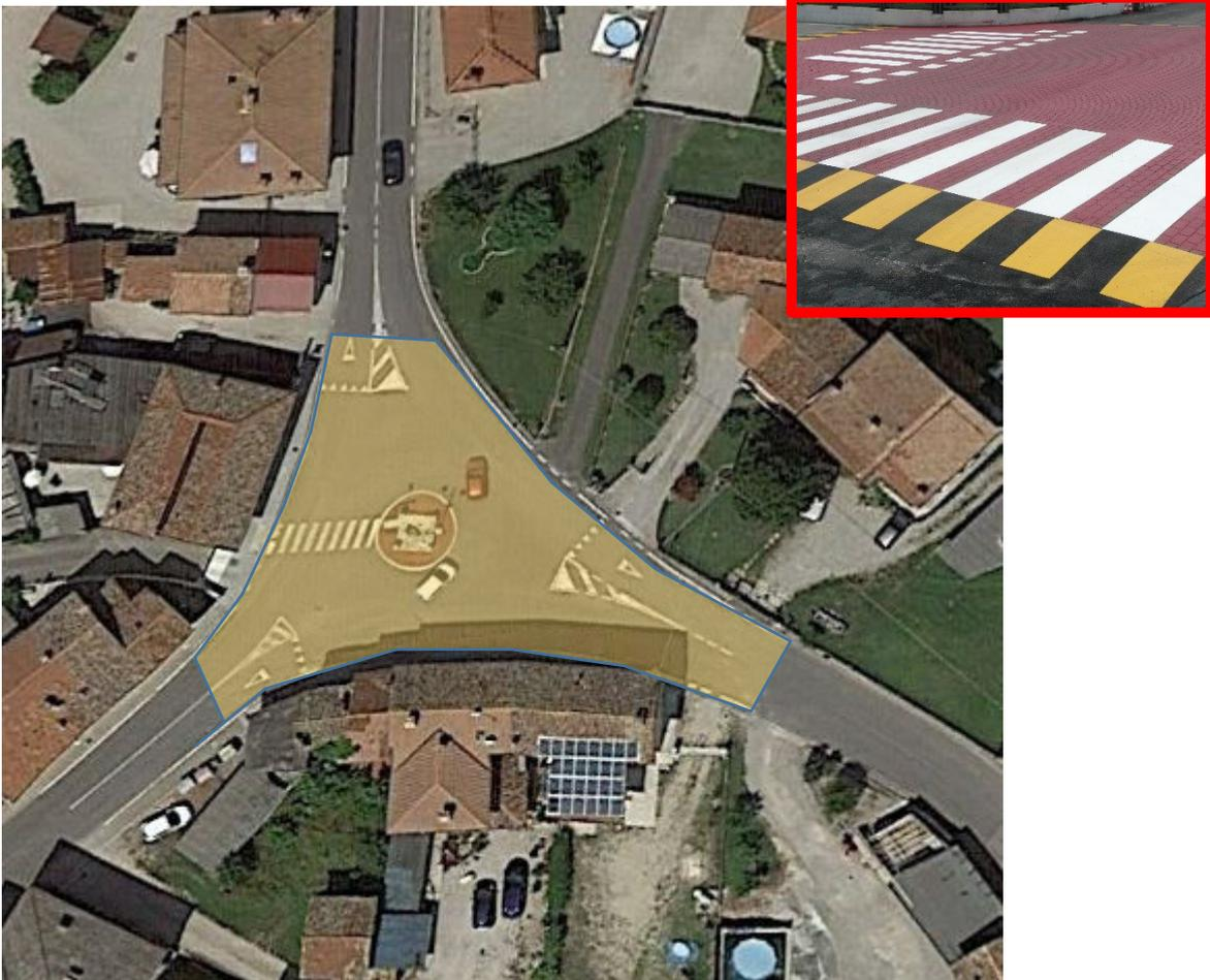
Le indicazioni del Biciplan sono di realizzare una rotatoria rialzata al fine di ridurre la velocità.
